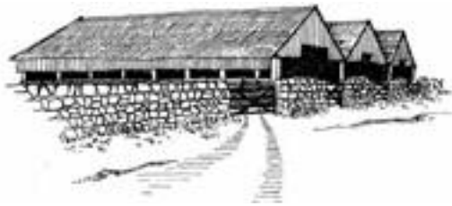
Utilise existing walls wherever possible
